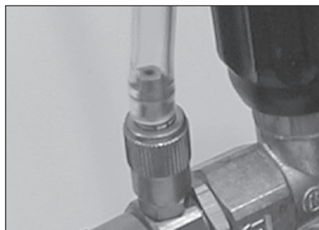
Figura 10 - Conecte el tubo de succión al conector dentado
